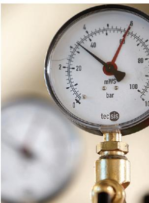
Druckmesser an einer solarthermischen Anlage © Gust/Berliner Energieagentur GmbH
